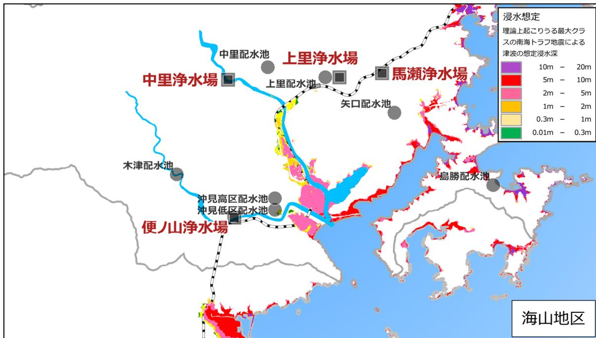
図 3-6 津波による浸水被害予測結果と水道施設位置
